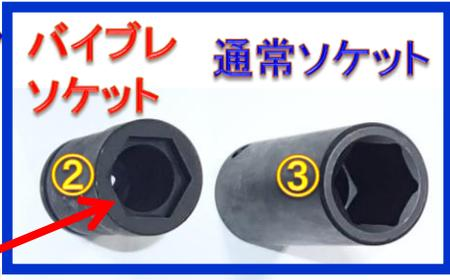
スラッジを粉々にして固着を解消しボルトを折ることもなく取り外すことができます。ここでの注目ポイントは、上記②のソケット先端形状になります。通常ソケットの場合、③のように先端面からストッパーまでの距離が深く、通常のボルトナットは全てソケット内に入り込んでしまい、振動がボルトに伝達されませんが、②のバイブレソケットは先端面からストッパーまでの距離が短く④のようにソケット先端とボルトがねじ込まれている台座との間に隙間ができてボルトのヘッド部にダイレクトに振動が伝わりサビやスラッジによる固着を解消します。
