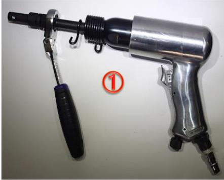
必要なサイズのバイブレソケットを取り付け、外すボルトに被せてエアハンマーを作動させるだけ！あとはエアハンマーを通じてバイブレソケットによる強烈な振動が固着したサビや
