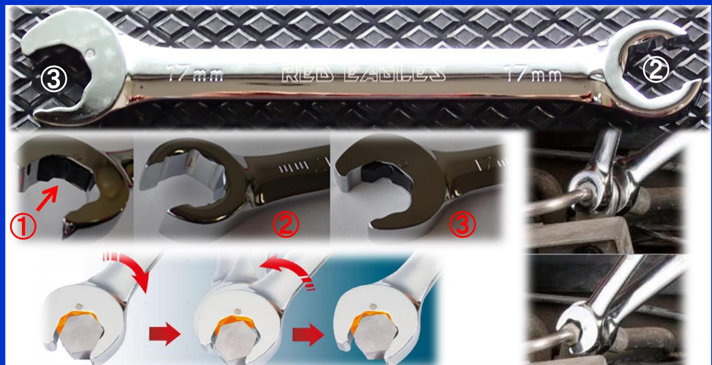
①独自のパウル埋め込みラチェットリング構造により、フレアナットレンチでありながら、一動作ごとにレンチを差し替えることなく、通常のラチェットレンチと同様の動きで締め、緩めの作業ができます。
